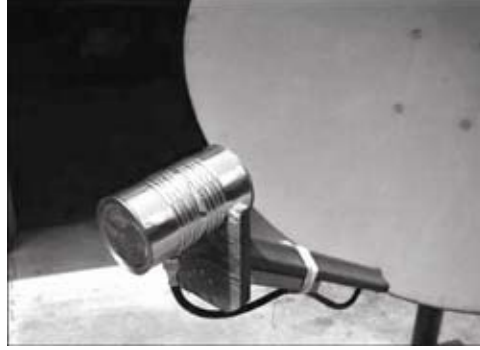
شكل 4.10: هوائي قرني مصنوع من علبه كونسروة معدنية.
