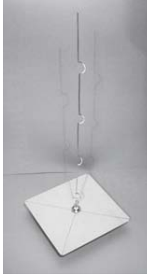
شكل 4.29: ينبغي أن يبلغ طول الهوائي المكتمل 42.5 سم من سطح الصفيحة وحتى نهاية السلك.
