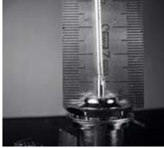
شكل 4.39: يشكل طول السلك عاملاً فائق الأهمية في تحديد أداء الهوائي.
