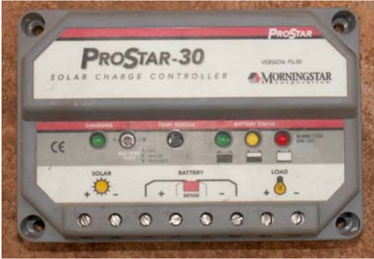
شكل 7.3: منظم لشحن الطاقة الشمسية باستطاعة 30 أمبير.
