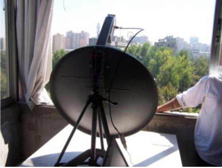
شكل 11.17: محطة لاسلكية مع هوائي قطعي Parabolic يستخدم للبث المباشر لوقائع مهرجان البرمجيات الحرة في سانتياغو Santiago-2006 FLISOL.
