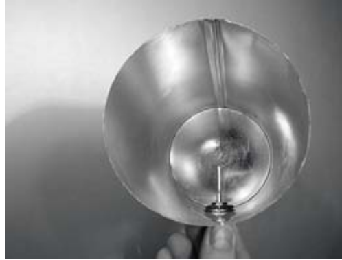
شكل 4.41: هوائي العلبة المعدنية المكتمل.
