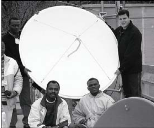
شكل 4.11: هوائي طبق ذو سطح مصمت.
